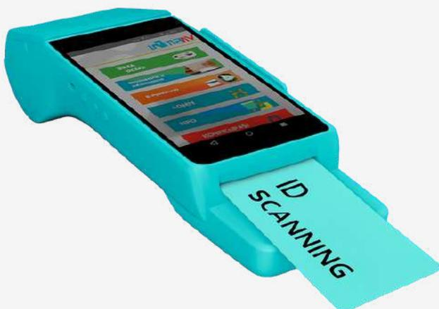
ID Scanning merupakan perangkat pemindai e-KTP yang secara otomatis merekam dan mengidentifikasi data pengunjung ketika memasuki area pelabuhan. Berkat teknologi yang cepat dan presisi, alat ini berperan penting dalam proses verifikasi identitas, memperkuat sistem keamanan, serta mempercepat akses masuk ke wilayah pelabuhan.
